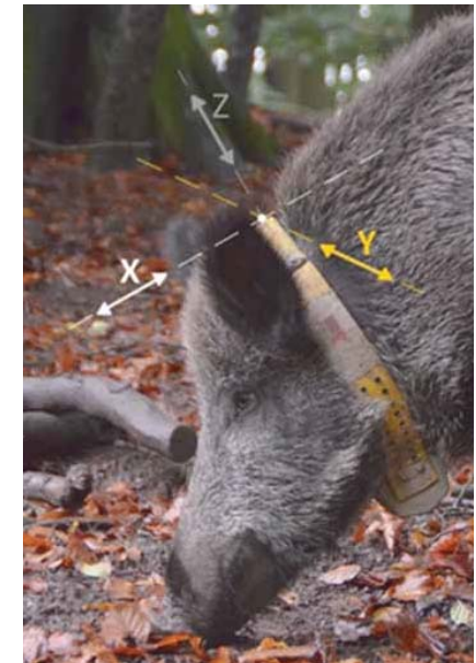
Abbildung 1: Verwendetes GPS-GSM-Senderhalsband der Firma VECTRONIC Aerospace GmbH, Berlin mit integriertem Beschleunigungssensor. Der Sensor sitzt oben am Senderhalsband, die Orientierung der Messachsen wird in der Abbildung mit Pfeilen dargestellt (Foto: S. Thoma).
